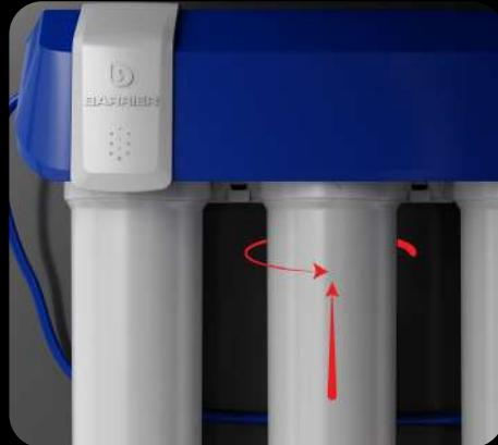
Вставьте новый фильтроэлемент в блок фильтра и поверните по часовой стрелке.
