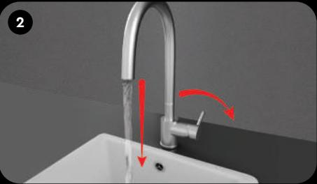
Откройте кран холодной воды на смесителе, чтобы сбросить давление в трубе. Затем закройте кран.
