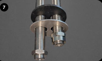
Наденьте на кран нижнюю прокладку, стопорную шайбу и гайки. Короткий резьбовой хвостовик крана предназначен для подключения очищенной осмосом воды, длинный – для минерализованной.
