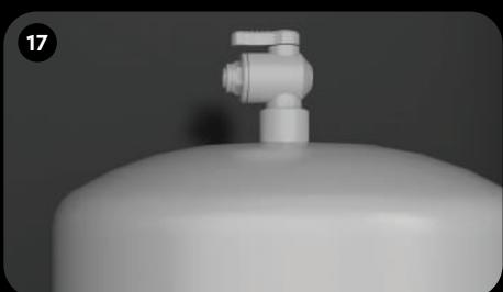
Установите кран на накопительную емкость. Оберните резьбу двумя-тремя слоями ленты ФУМ (приобретается отдельно) для герметизации. Рукой закрутите кран до упора.
